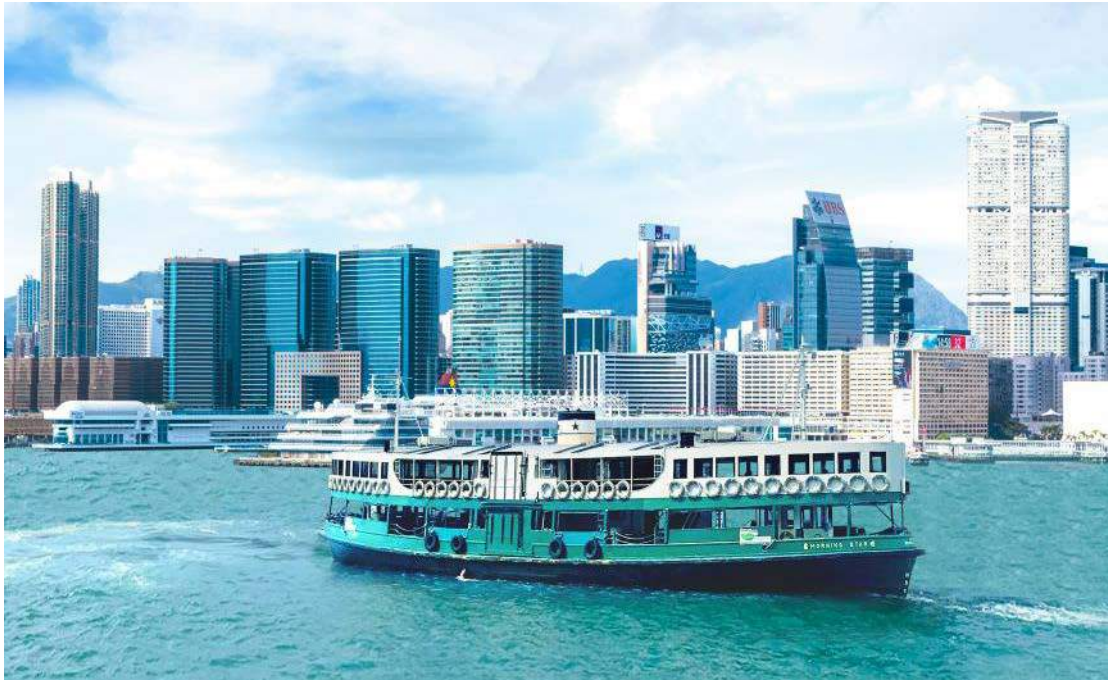
圖三：「曉星」輪為香港第一艘以柴油發電及電能推動、行走日常航線的低排放環保渡輪。
